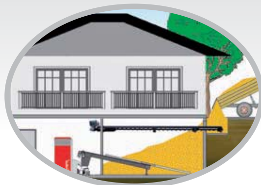
Distribución espacial con transporte de astillas de madera en la cubierta para el llenado óptimo del depósito.
