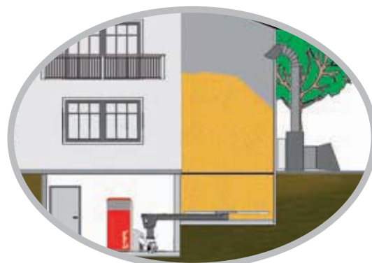
Llenado del depósito con ventilador.
