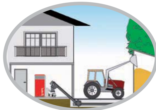
Longitud posible del canal del tornillo sin fin superior a 15 m (varios componentes).
