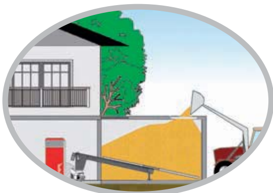
Llenado del depósito con cargador frontal.
